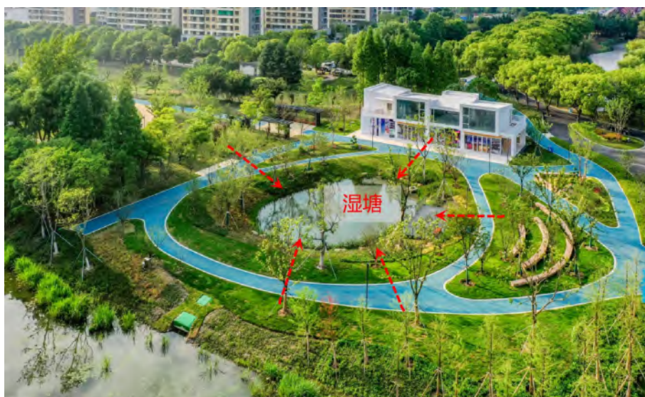
图 7-15 城市水系滨水湿塘汇水坡向图
