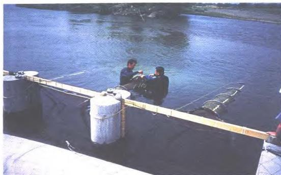
追蹤調查的實施狀況 1(爲了要捕捉上溯魚道的魚類，在魚道上游端設置袋網)
