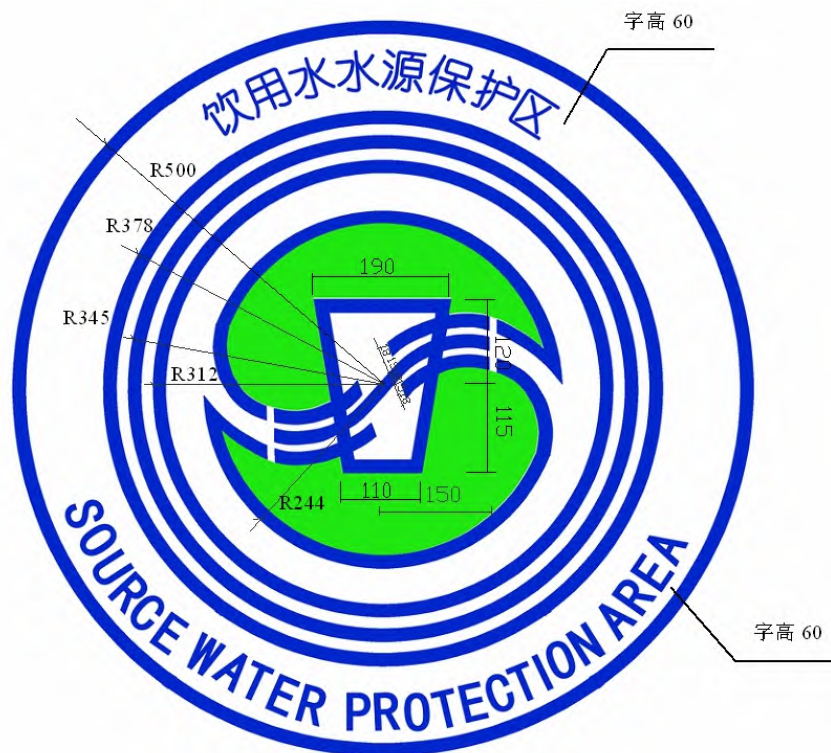
图 4 饮用水水源保护区图形标志尺寸比例（图中线条宽度为 18）
