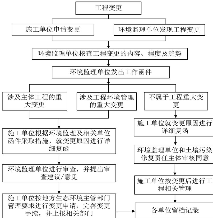
图 3 土壤污染修复工程变更处理流程图
