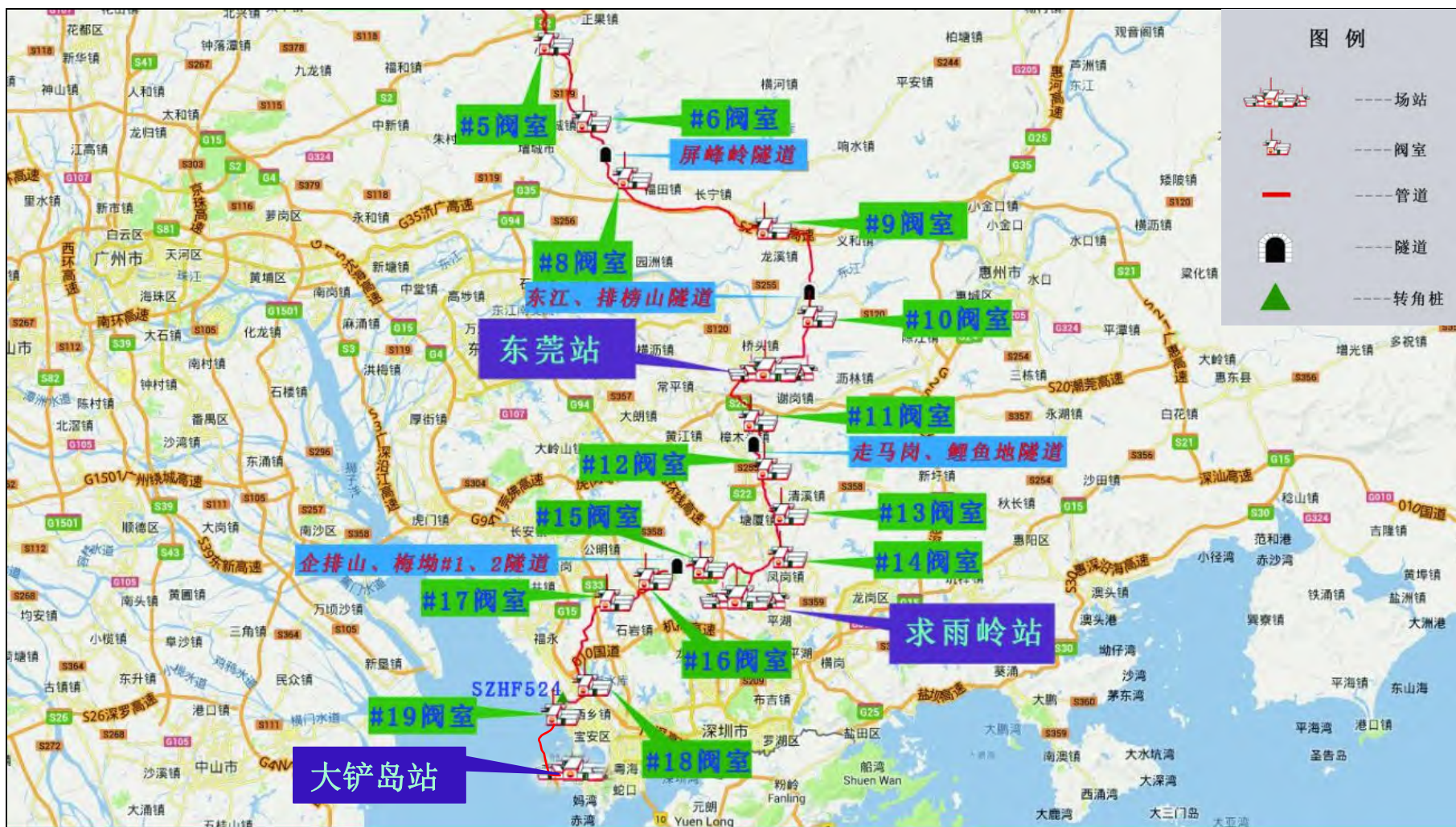
图 2.1-2 工程管道线路走向图 (2)
