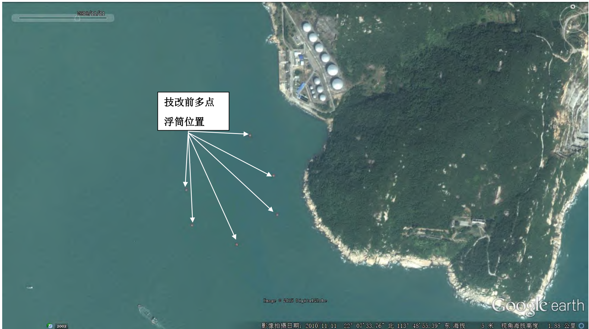
图 2.3-3 技改前多点浮筒布置影像图
