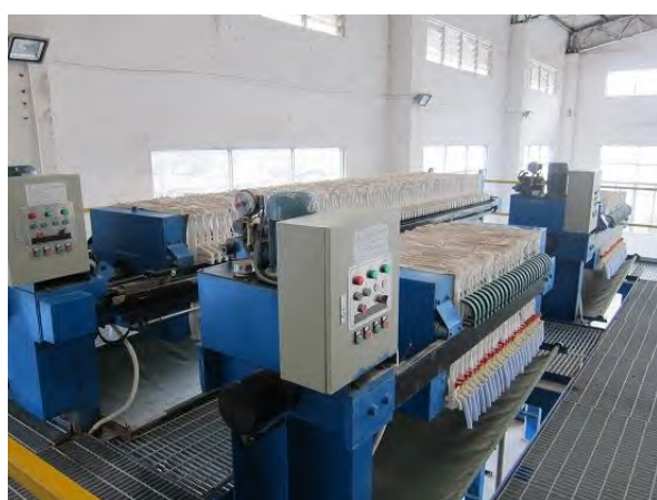
照片 3-3 生产废水压滤机
