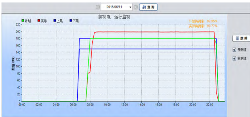
图 6-2 第二套机组第二天负荷曲线
