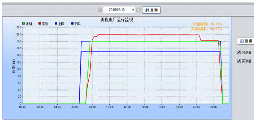
图 6-1 第二套机组第一天负荷曲线
