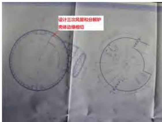
照片 17 三次风管和分解炉壳体边缘相切
