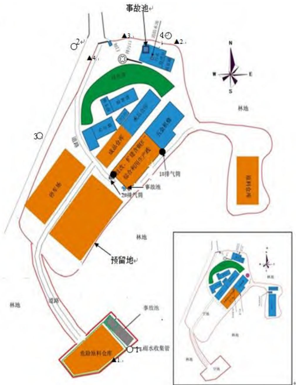
图 3-2 改扩建项目总平面布置图 (●排气筒, ○环境空气监测点, ▲噪声监测点)
