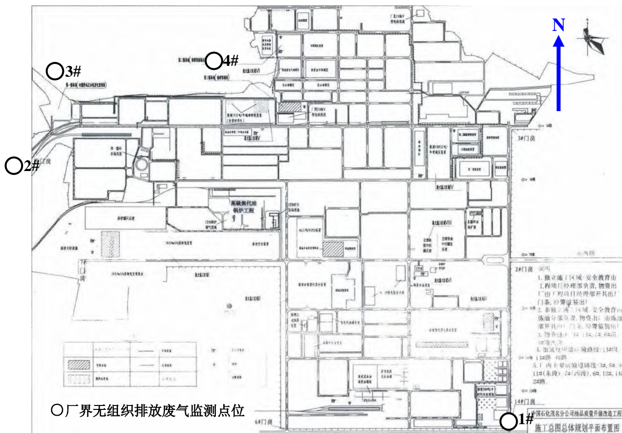
图 7-1 厂界无组织排放监测点位示意
