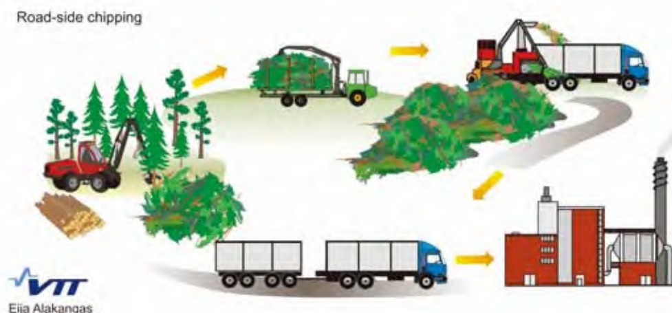
图 5.2 在路边（贮木场）切削的木屑生产链
