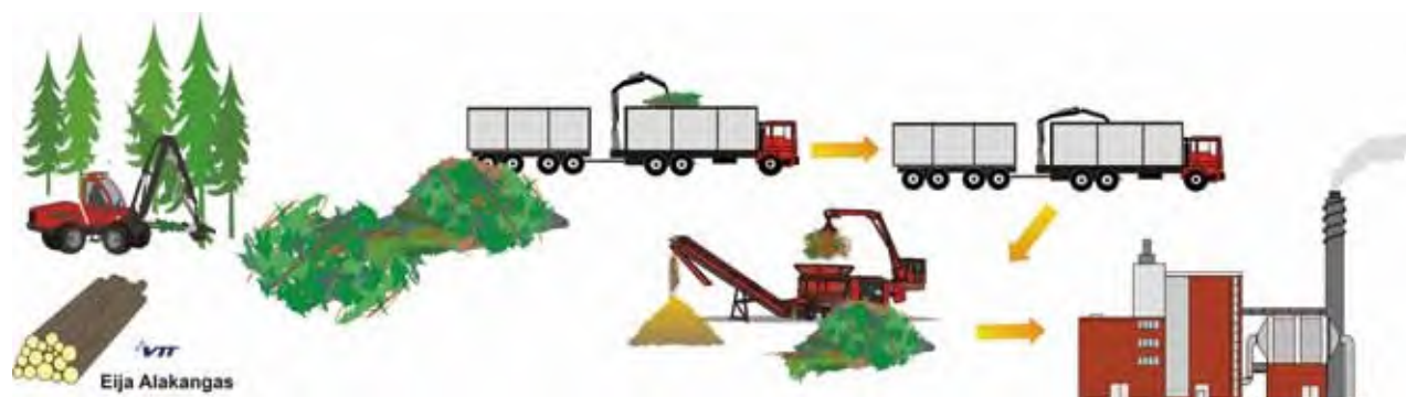
图 5.5 在终端设备切削松散型废弃物的木屑生产链
