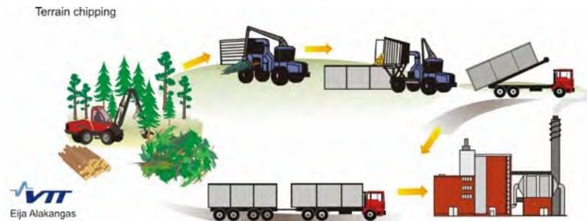
图 5.4 在来源地切削的木屑生产链
