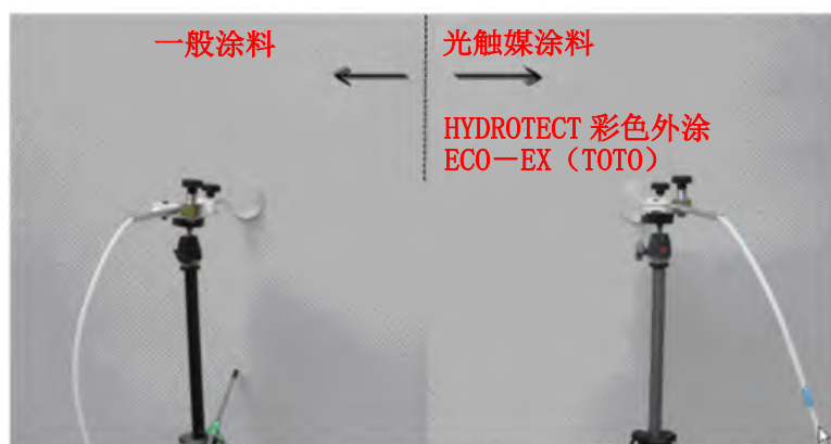
图 2. 采样 ～ 对墙面附近（吸气口与墙面的距离约为 1mm）的空气进行采样
