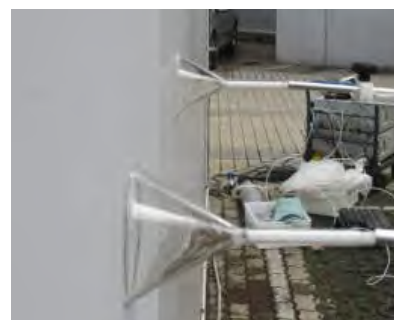
图 2. 采样 ～ 对墙面附近（吸气口与墙面的距离约为 1mm）的空气进行采样
