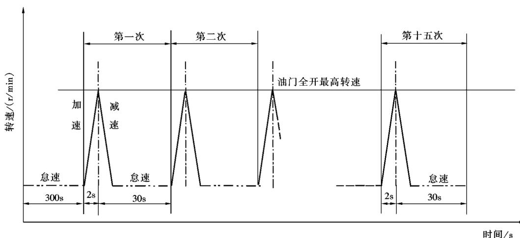
图 A. 3 排烟测量急加速法运行模式
