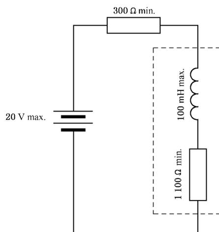
图 A.7 简单电感电路
