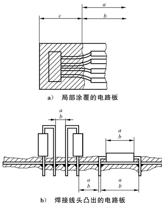
图 4 印制电路板的爬电距离和电气间隙
