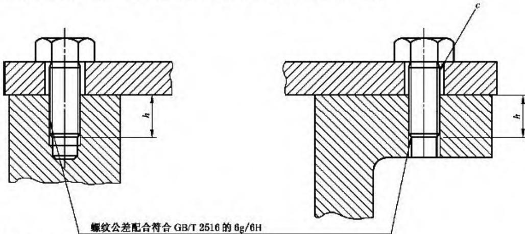
$h \geq$  紧固螺栓的螺纹外直径;
