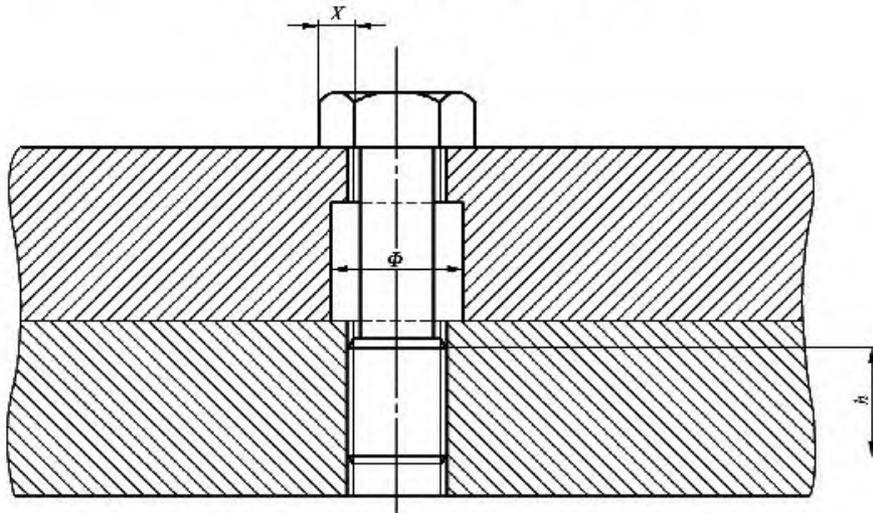
$\Phi$  与螺纹牙形对应的标准光孔直径;
