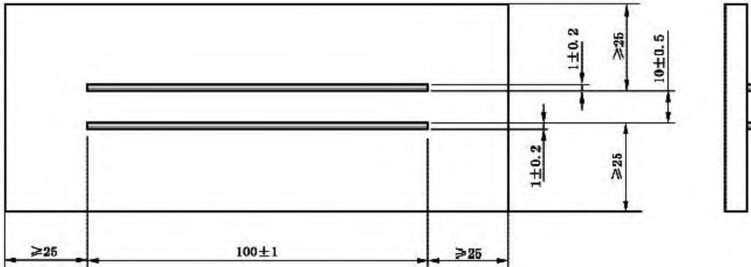
图 5 涂导电漆电极的试件
