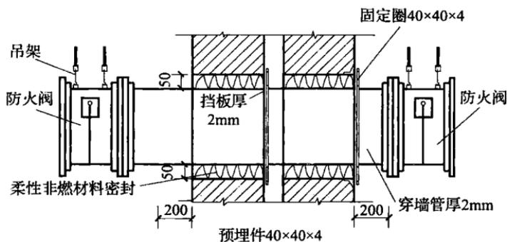
图 9 变形缝处的防火阀
