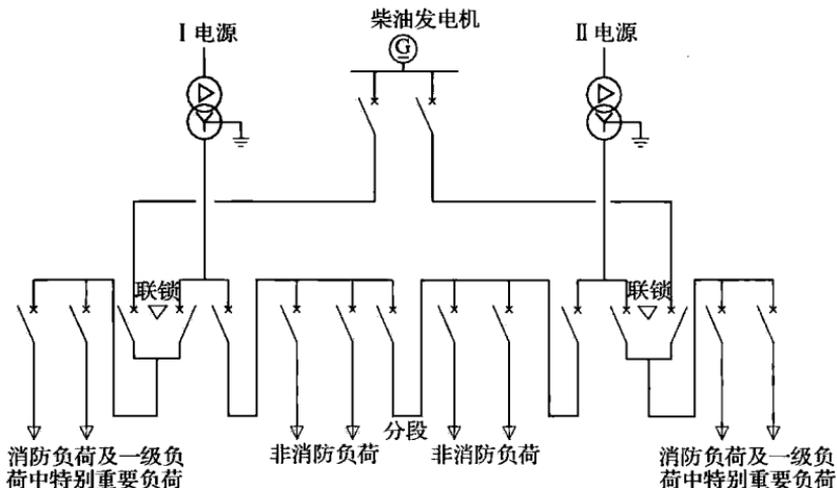
图 12 柴油发电机作为消防设备的备用电源的配电系统分组方案
