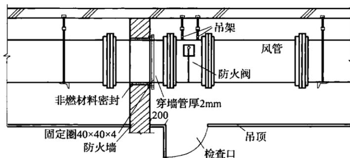
图 10 防火阀检修口设置示意图
