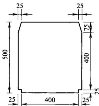
图 13 车行横通道的断面建筑限界(cm)
