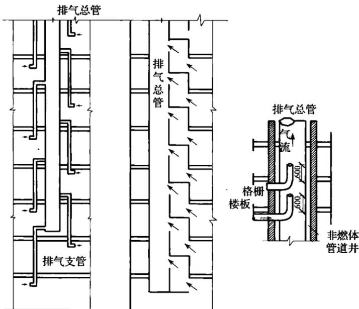
图 8 排气管防止回流示意图
