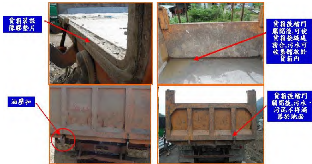
圖3-19 砂石車貨箱設置阻隔設施實照
