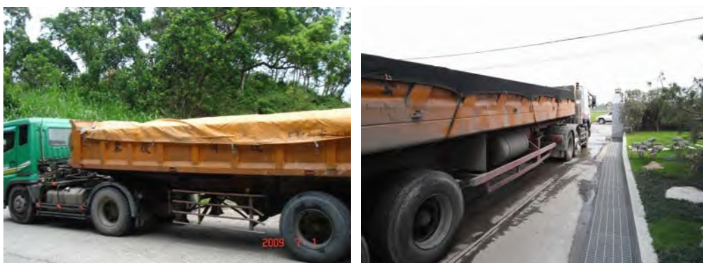
圖3-17 砂石車貨箱覆蓋防塵布(網)實照
