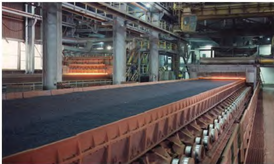
圖 2.7 一貫作業煉鋼燒結爐製程
