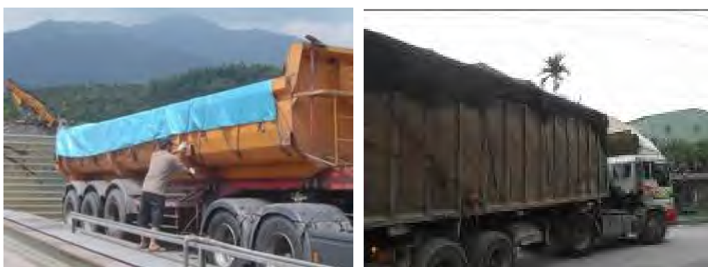
圖3-17 砂石車貨箱覆蓋防塵布(網)實照
