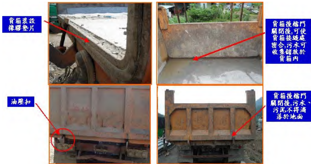
圖3-19 砂石車貨箱設置阻隔設施實照
