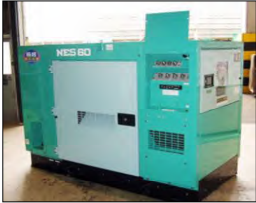
圖 3 低噪音型發電裝置
