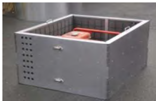
圖 11 機具部分設備加裝隔音罩
