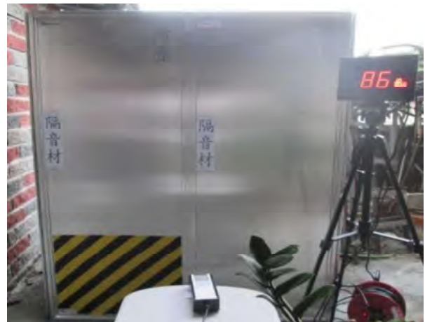
圖 21 防音隔屏實測示意圖
