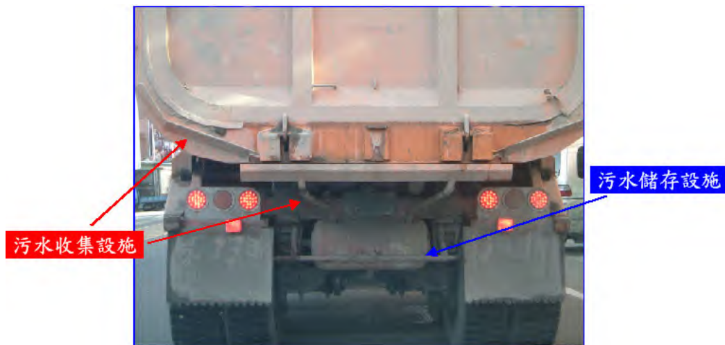
圖3-18 砂石車貨箱設置污水收集、儲存設施實照
