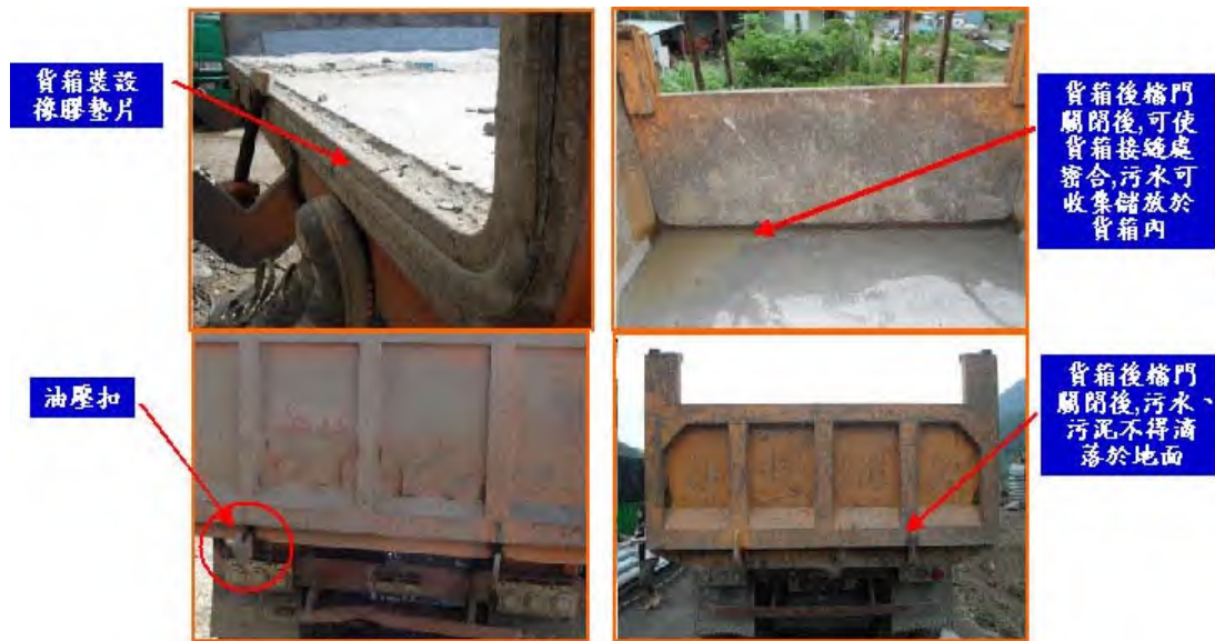
圖3-19 砂石車貨箱設置阻隔設施實照
