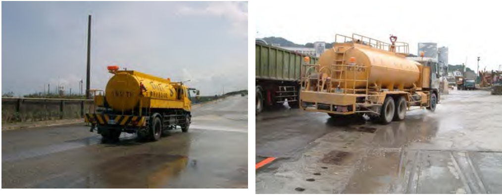
圖3-23 洗街車作業實照
