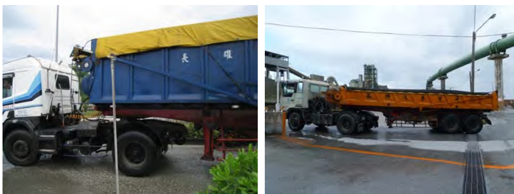
圖3-17 砂石車貨箱覆蓋防塵布(網)實照
