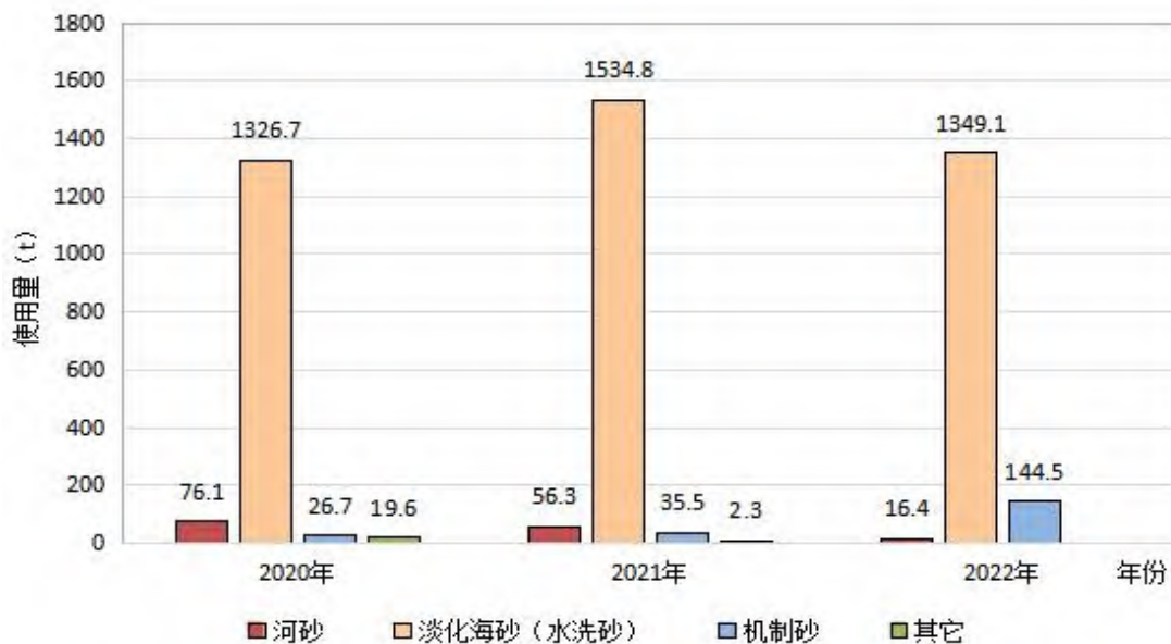
图 3-6 东莞市近年来预拌混凝土生产原材料使用情况
