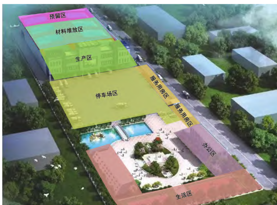
图 3-10 绿色环保型混凝土企业场地功能布局示意图
