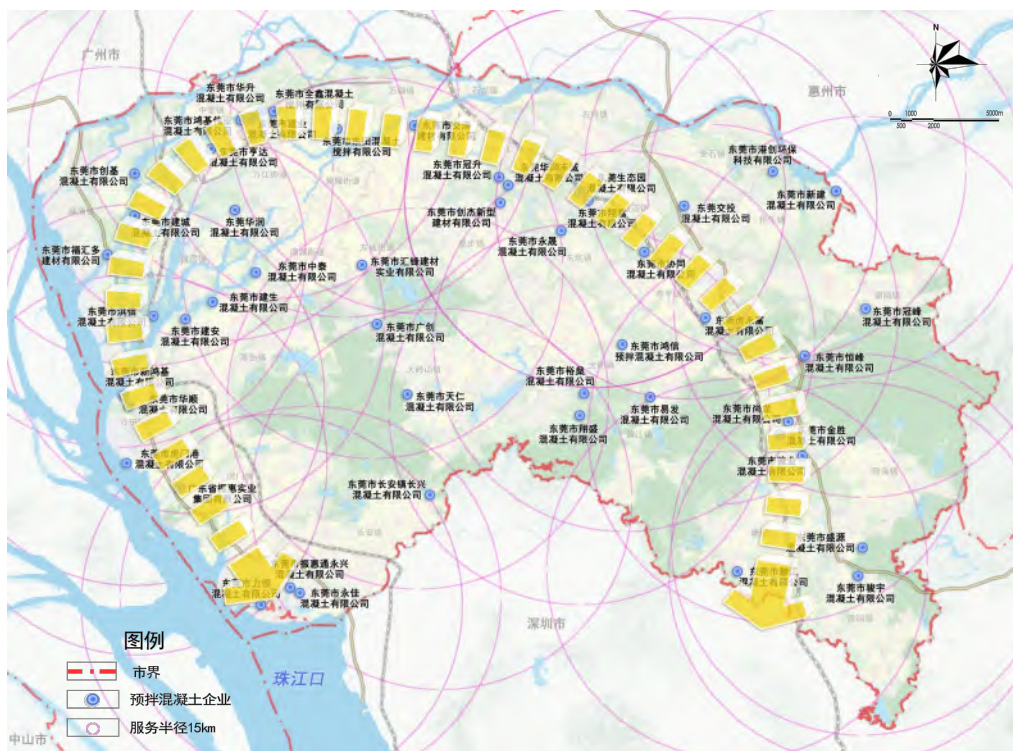
图 5-1 东莞市预拌混凝土企业最佳服务范围图
