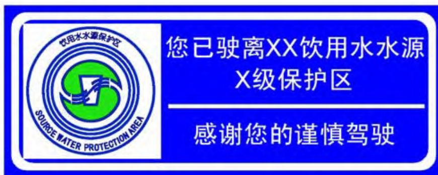
图 8 驶离饮用水水源保护区道路告示牌背面示意图（一般道路）
