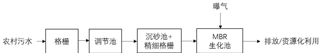
图 6.3.25 MBR 工艺流程图
