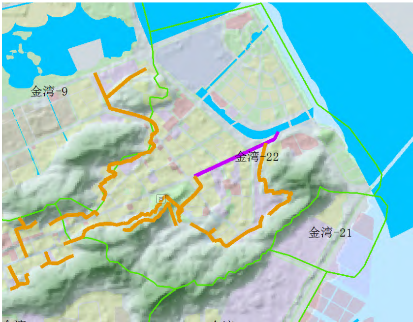
图 7-31 利用市政雨水管渠承接山洪
