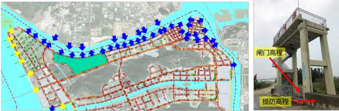
图 2-44 临海区域直排海排口及水闸防护高度不达标示意
