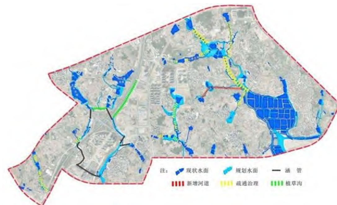
图 5-5 源头减排设施与城市水系联通系统示意
