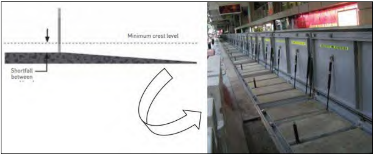
图 3-22 新加坡防水闸设施原理及实物图
