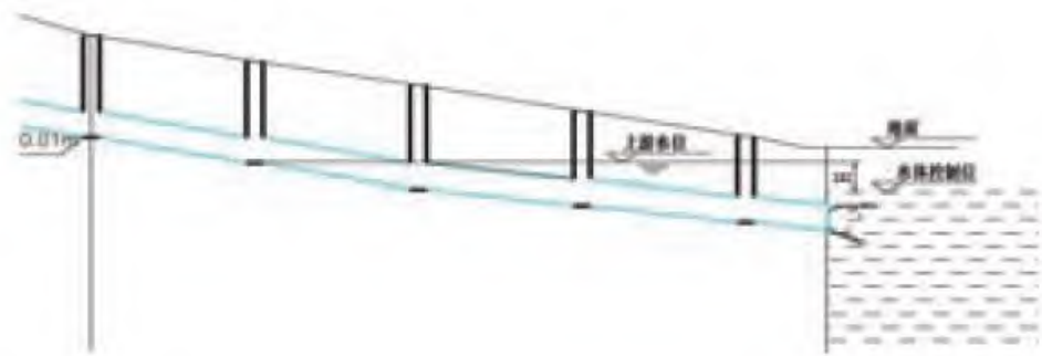
图 6-5 淹没出流时雨水管道纵断面示意图
