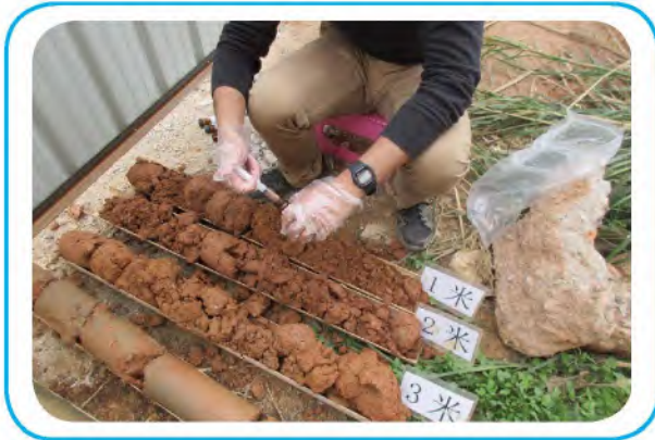
◆ 采样人员通过无扰动取样器对关闭搬迁企业地块进行土壤样品采集。
