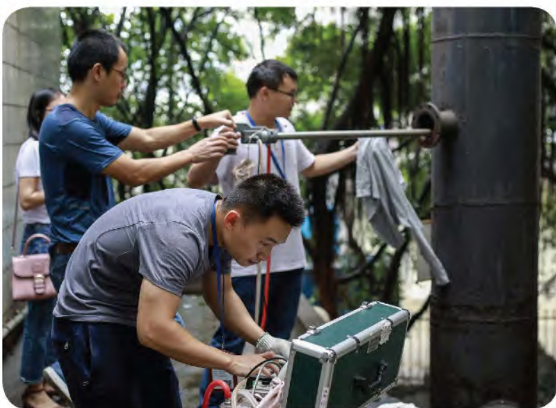
◆ 环境监测人员对白云区重点监控企业的锅炉烟囱进行检测
