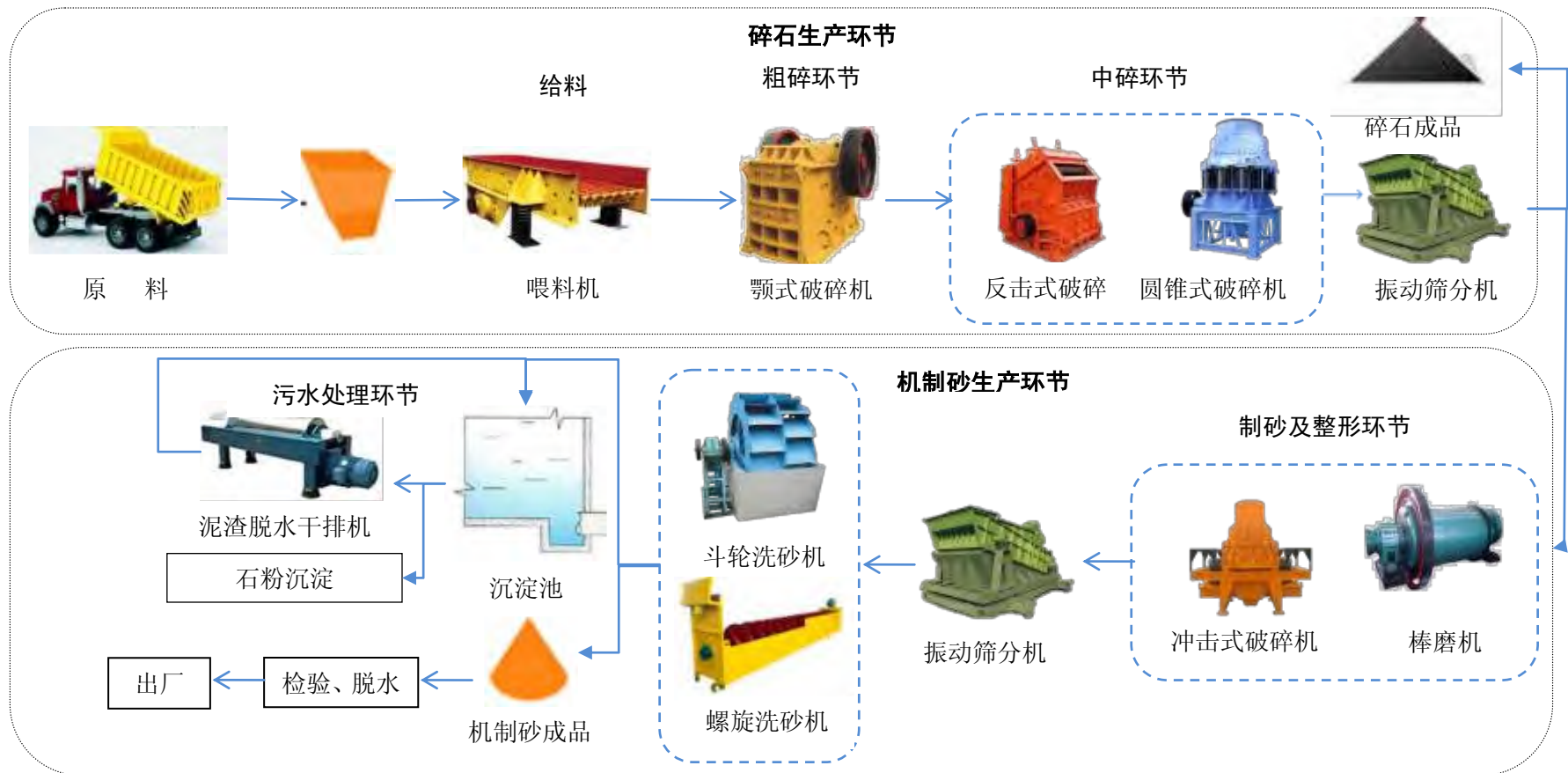
砂石联产湿法制砂流程图
