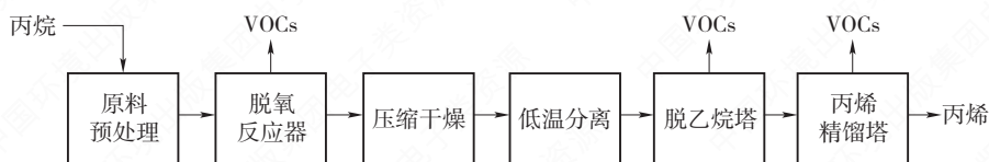
图 1-11 PDH 制丙烯生产工艺流程与 VOCs 排放环节示意
