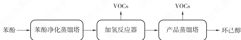
图 1-17 苯酚加氢制环己醇生产工艺流程与 VOCs 排放环节示意
