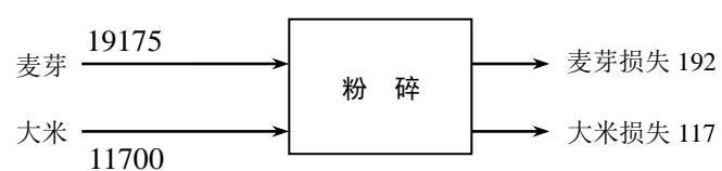
图 3-4 审计重点（酿造车间）物料流程图（单位：kg/d）
