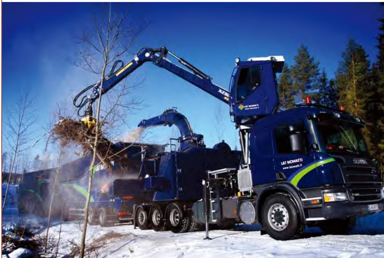
图 5.3 削片粉碎机卡车
