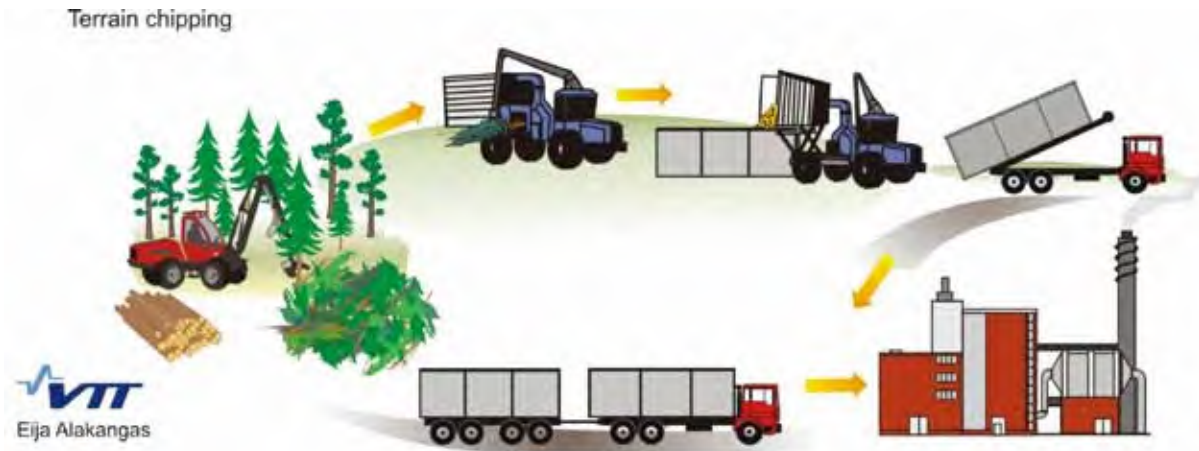
图 5.4 在来源地切削的木屑生产链
