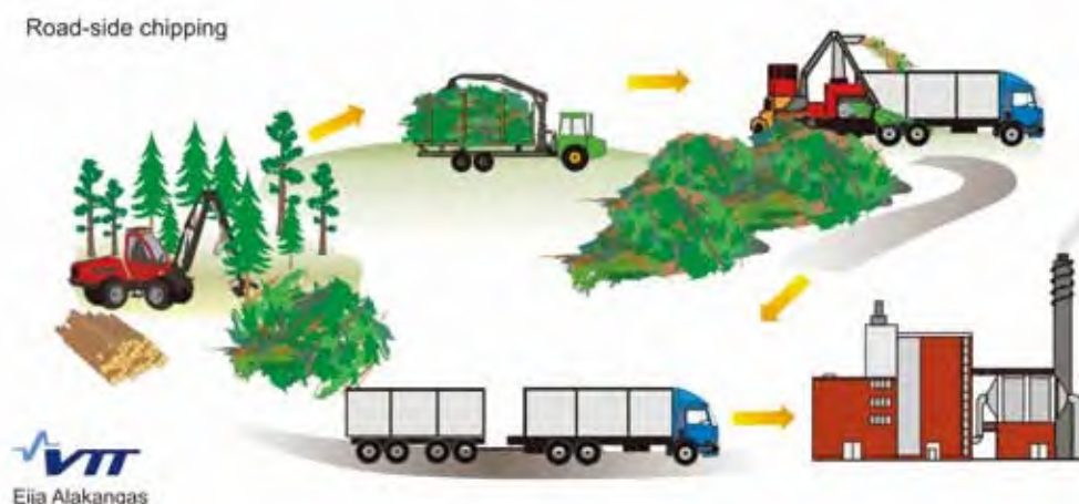
图 5.2 在路边（贮木场）切削的木屑生产链
