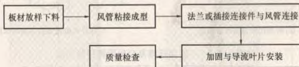
图 5.3.1 玻璃纤维复合风管与配件制作工序
