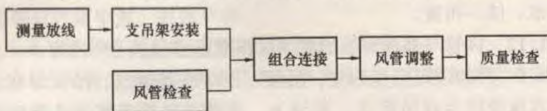
图 8.2.1 金属风管安装工序
