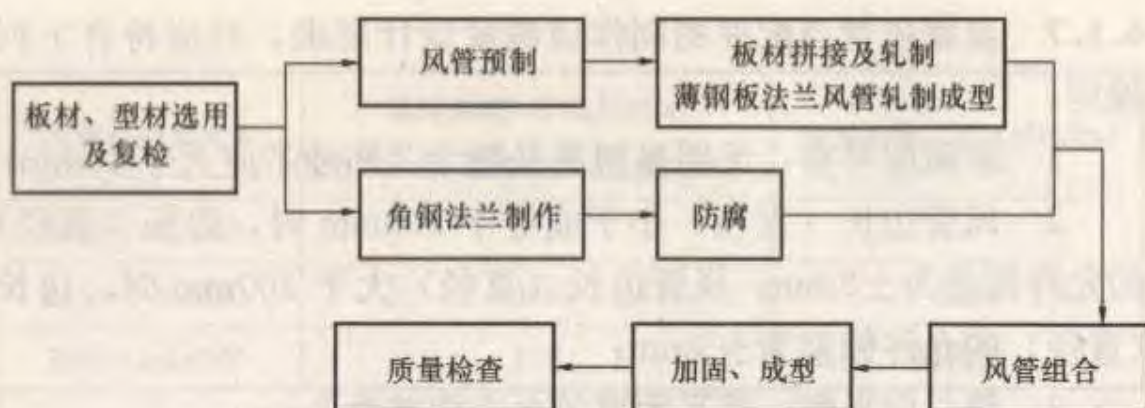
图 4.2.1 金属风管制作工序
