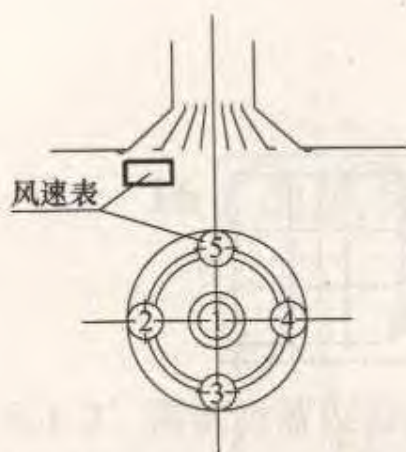
图 33 用风速仪测定 散流器出口平均风速
