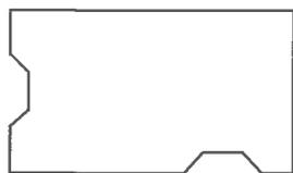
图 6.2.13 混凝土异形板桩截面图
