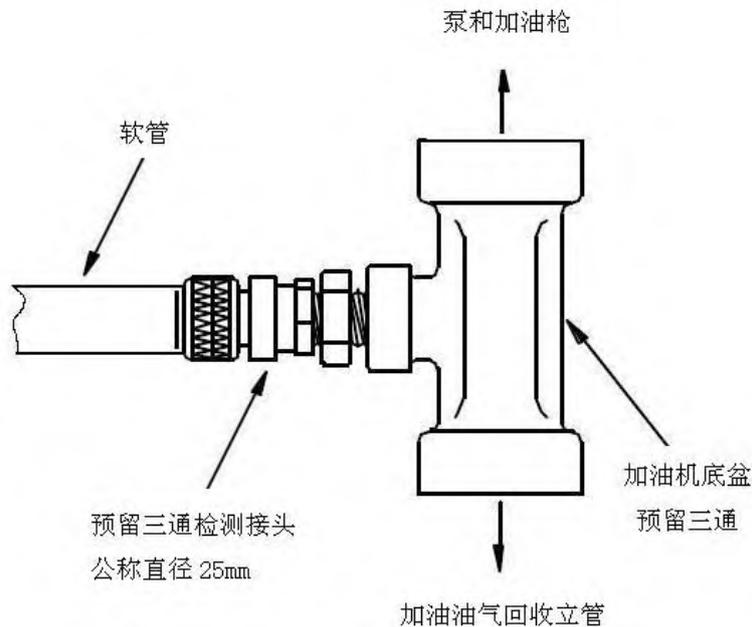
图 A.2 三通检测接头示意图
