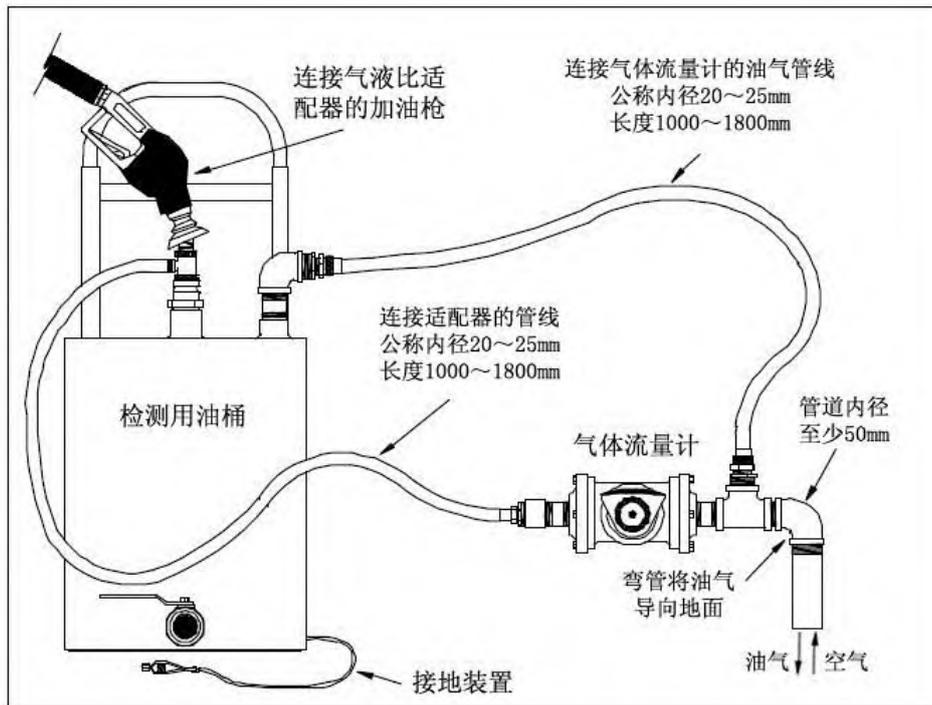
图 C.3 气液比检测装置安装示意图
