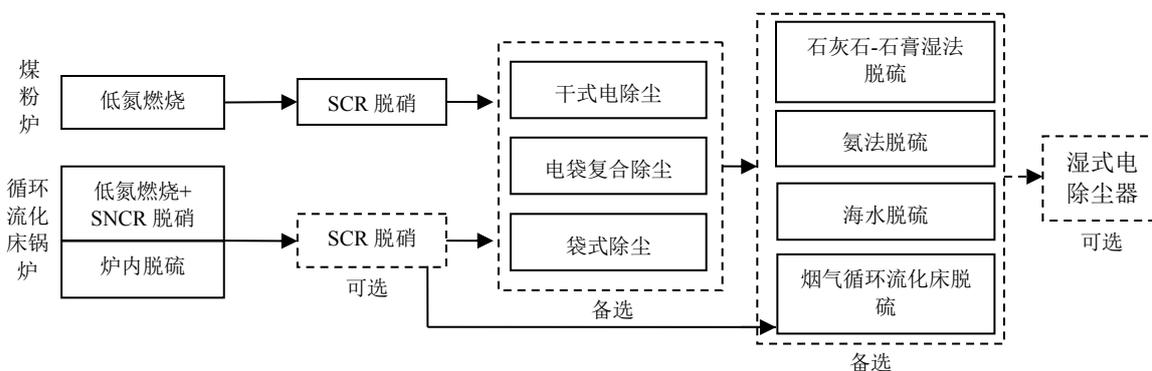
图 2 燃煤电厂超低排放技术路线
