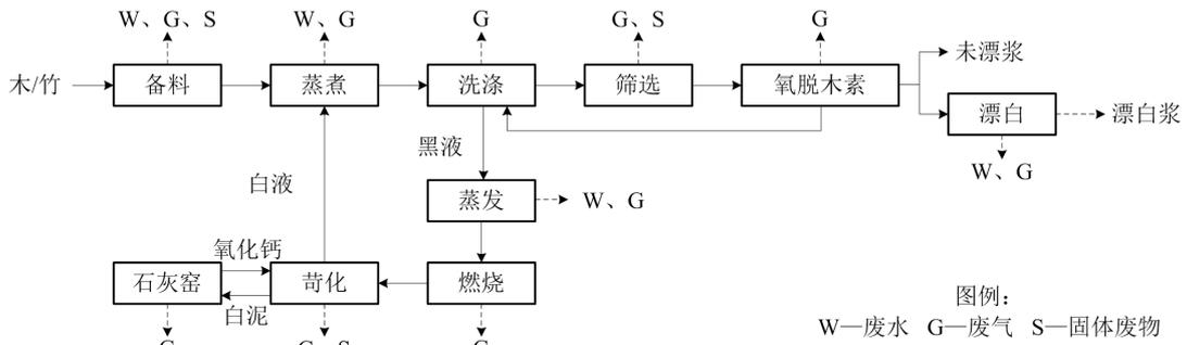
图 A.1 典型硫酸盐法化学木（竹）制浆工艺过程及污染物产生节点
