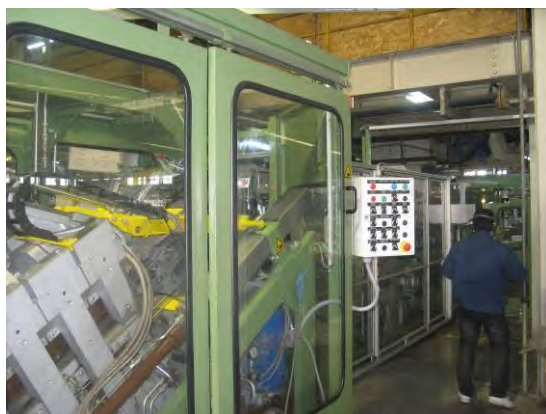
图 12 先进的管式电极挤膏工艺
