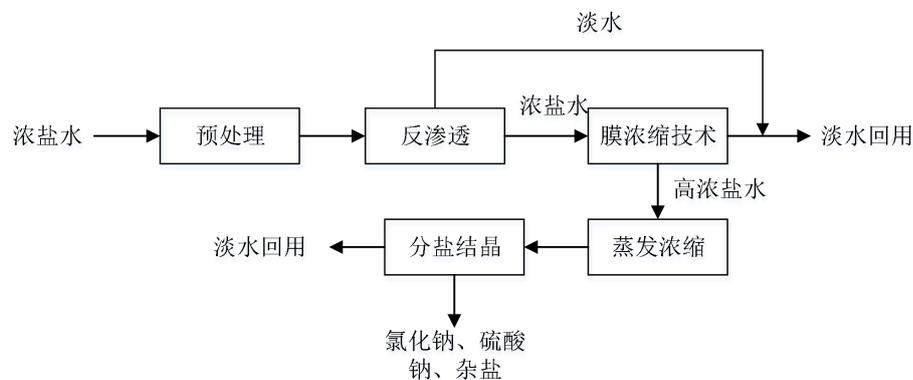
图 5 浓盐水“蒸发浓缩+分盐结晶”回用处理工艺路线
