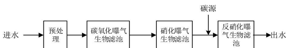
图9 曝气生物滤池-后置反硝化工艺
