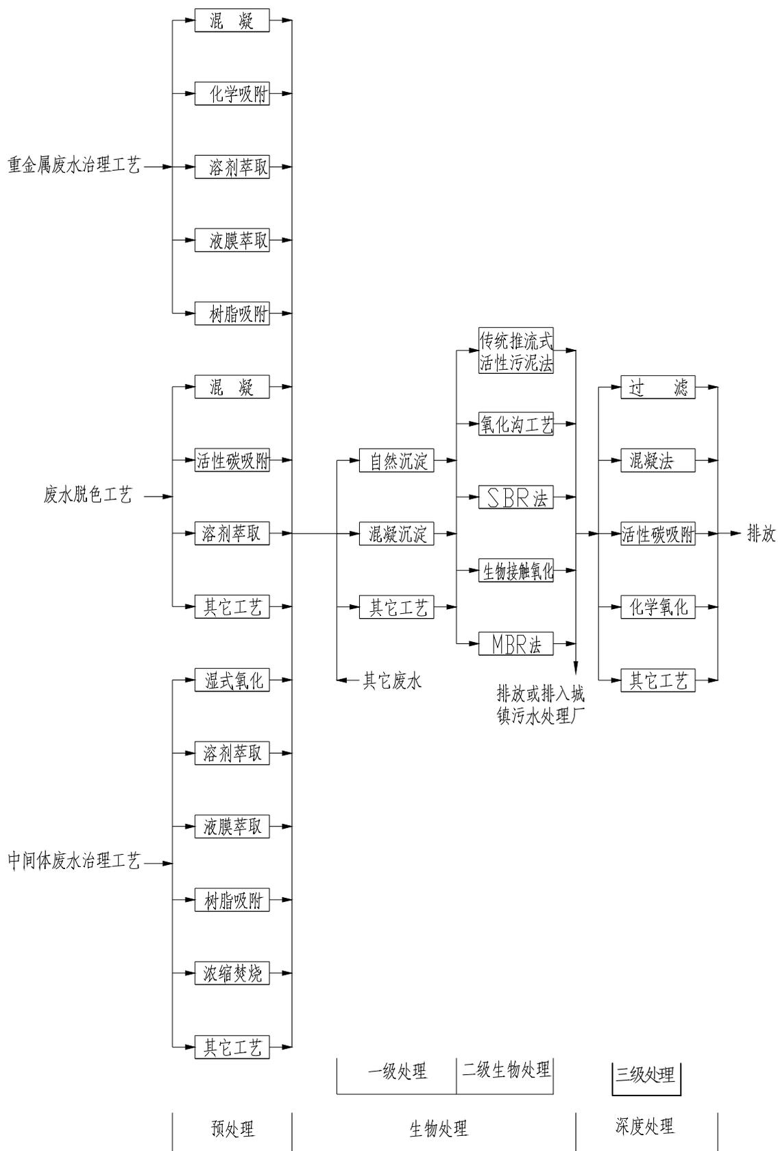
图 1 染料工业废水治理工程工艺流程图
