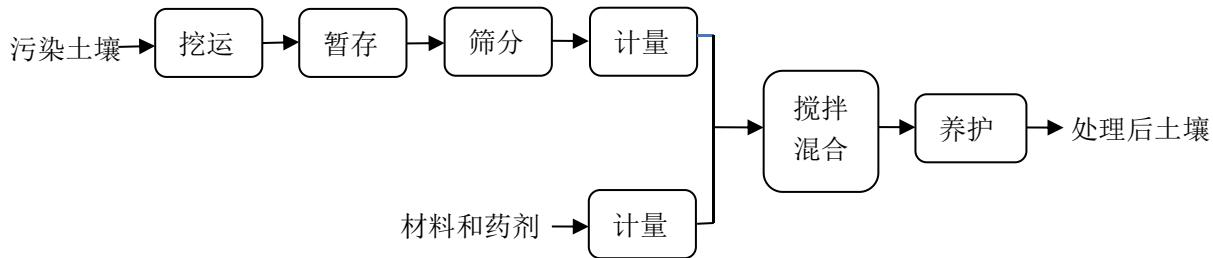
图2 异位固化/稳定化工艺流程图
