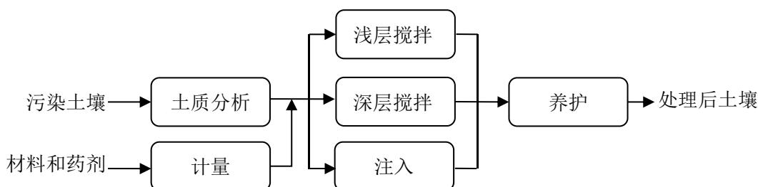
图1 原位固化/稳定化工艺流程图
