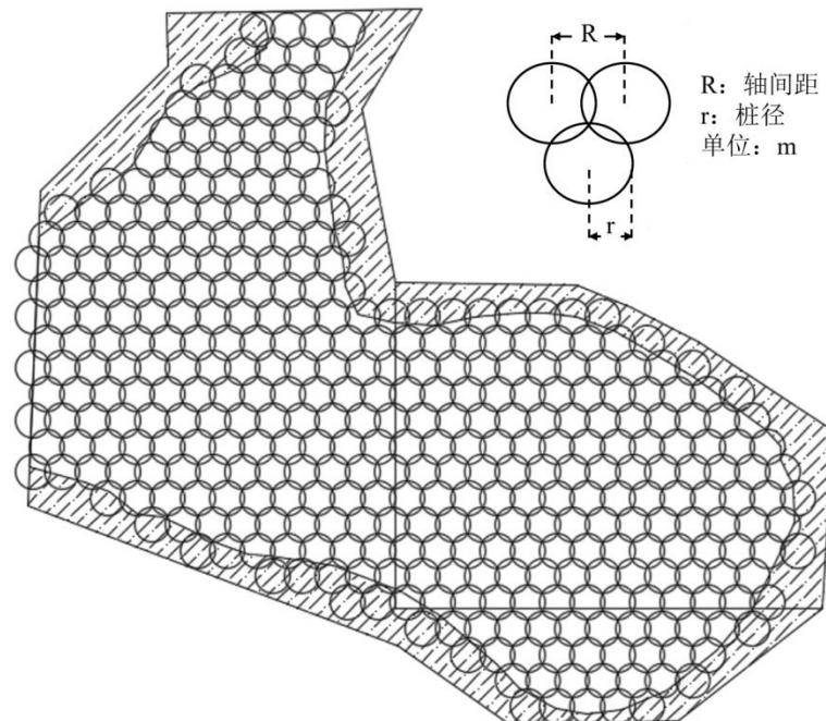
图 D.1 典型原位固化/稳定化搅拌柱布局及设计
