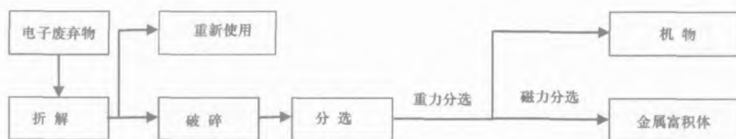
图 1 电子废弃物机械回收流程
