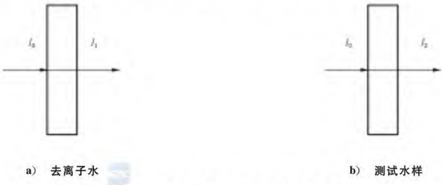
图 B.1 水体紫外线穿透率测量示意图
