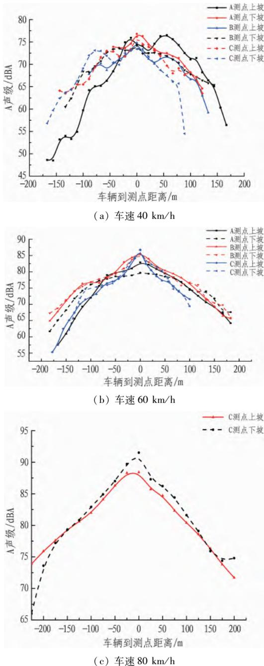
图 13 不同车速下隧道内单车噪声
