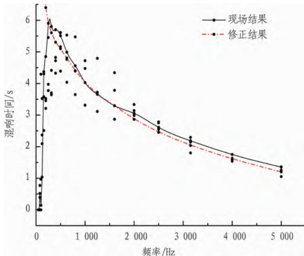
图 11 隧道内混响时间与频率的关系
