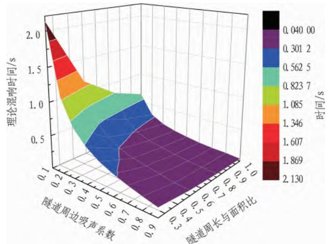
图 9 隧道噪声混响时间
