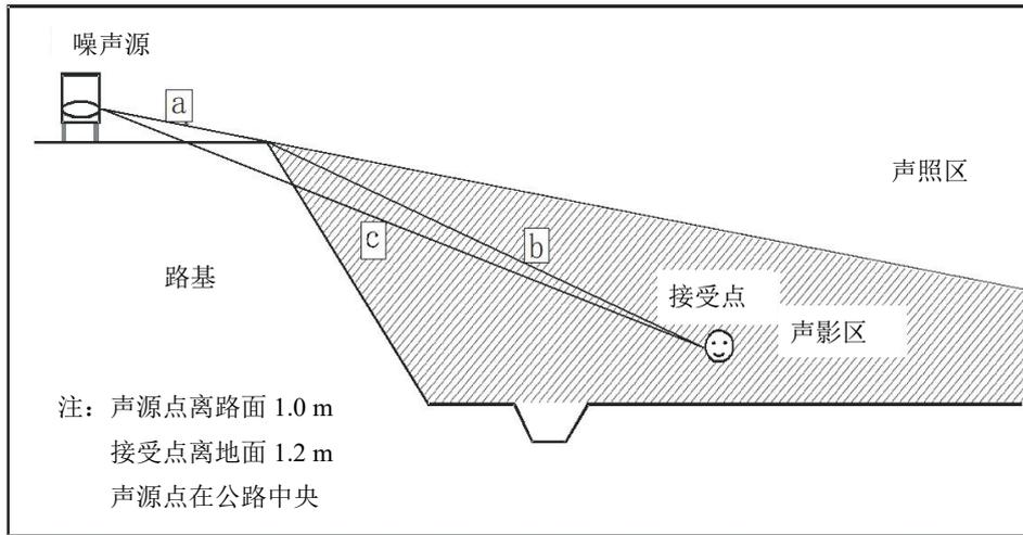
图 B.4 声程差 $\delta$ 计算示意图
