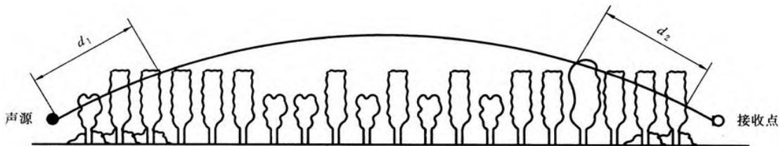
图 9 通过树和灌木时噪声衰减示意图
