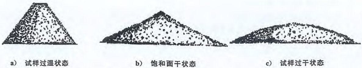
图4 天然砂饱和面干状态示意图
