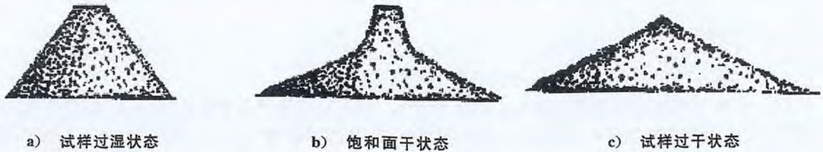
图5 机制砂饱和面干状态示意图
