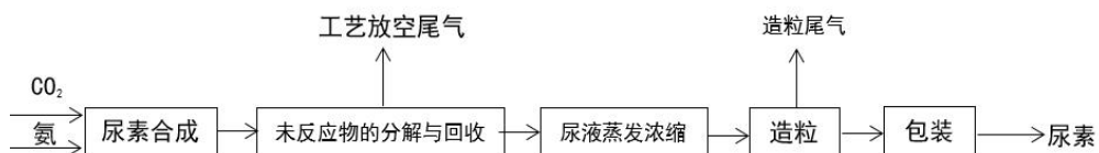
图 25-5 尿素生产工艺流程图
