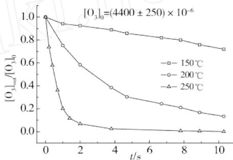
图2 臭氧无催化热分解试验结果
