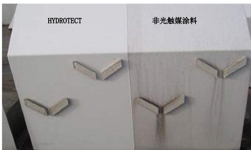
图10 加硅胶密封后的曝露实验（户外曝露，期间：1年）
