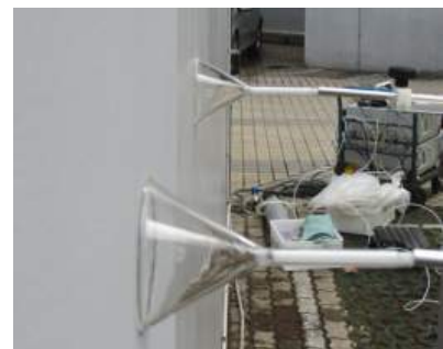
图 2. 采样 ~ 对墙面附近（吸气口与墙面的距离约为 1mm）的空气进行采样
