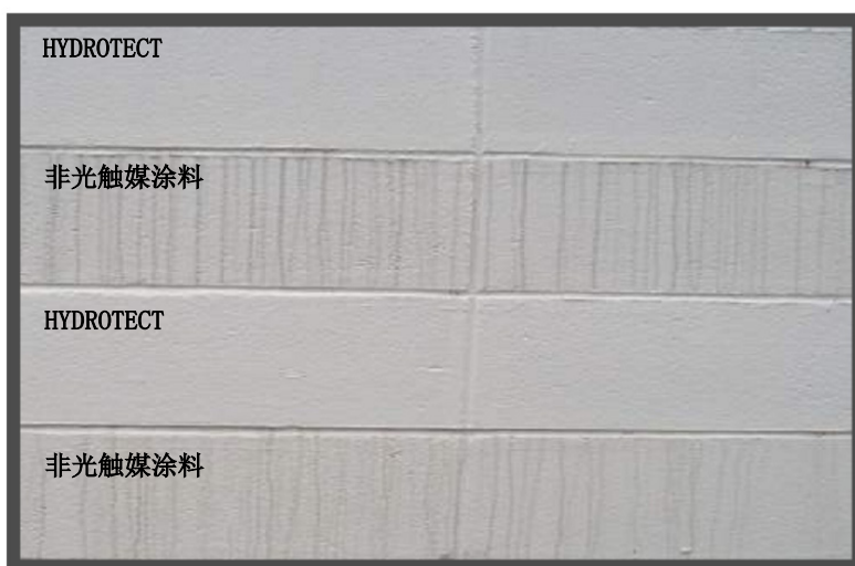
图9 HYDROTECT 涂料与非光触媒涂料的曝露实验（户外曝露，期间：1年）
