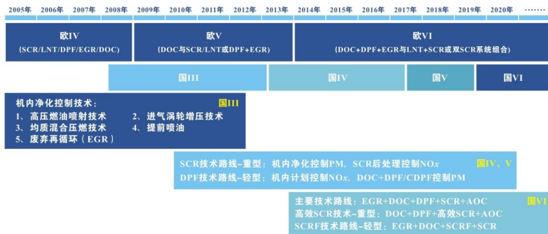
图 4.8 重型柴油车排放标准法规实施年限及相应控制技术
